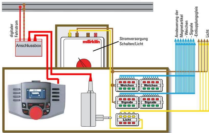
Digitales steuern und schalten mit der Mobile Station und Schaltpulten für Lichtstrom
